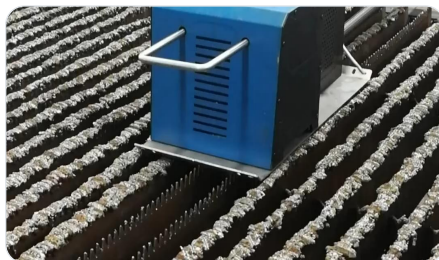
Narzędzia kruszą żużel z obu stron listwy
