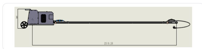
Ramię wydłużone — długość całkowita ok. 2519 mm
