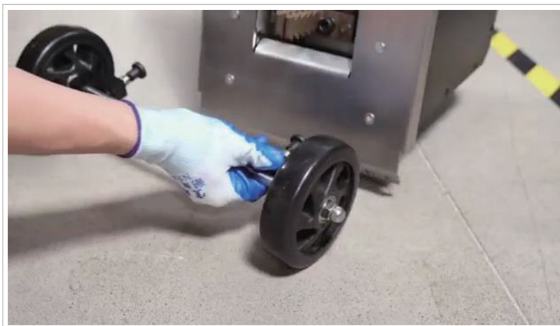
Rys. 4. Nasuwanie zespołu kół na przód płyty ślizgowej.
